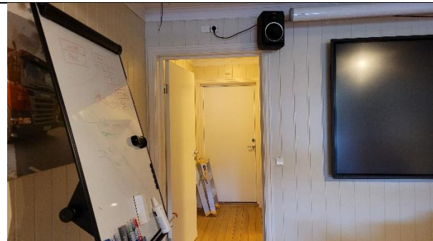
Bygg 1, 2.etg.: Utgang til internt trapp og dør til vestre, merkes med henvisningsskilt til utgang. I samme rom skal dør til lager ikke benyttes til rømning, da mottatte branntegninger viser utgang her.
