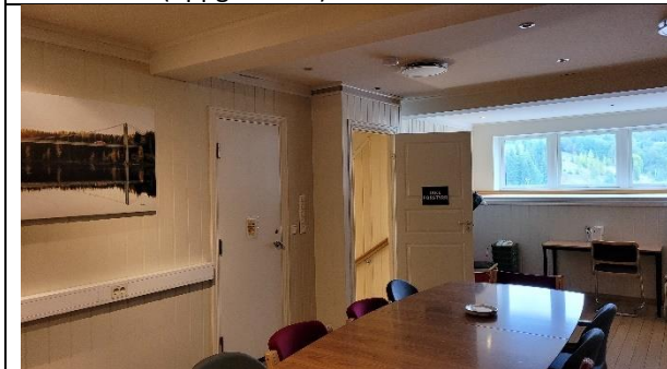
Bygg 1, 2.etg.: Utgang til internt trapp og dør til vestre, merkes med henvisningsskilt til utgang. I samme rom skal dør til lager ikke benyttes til rømning, da mottatte branntegninger viser utgang her.
